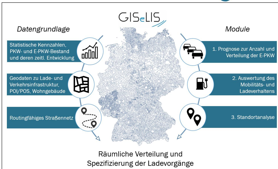
Abbildung 74: Funktionsweise des Standortmodells für LIS GISeLIS
